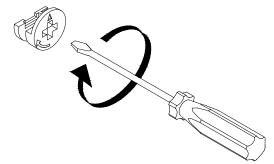
USE A FLAT HEAD SCREWDRIVER TO TIGHTEN THE CAM NUTS. A QUARTER TURN CLOCKWISE IS ALL THAT IS NEEDED.
